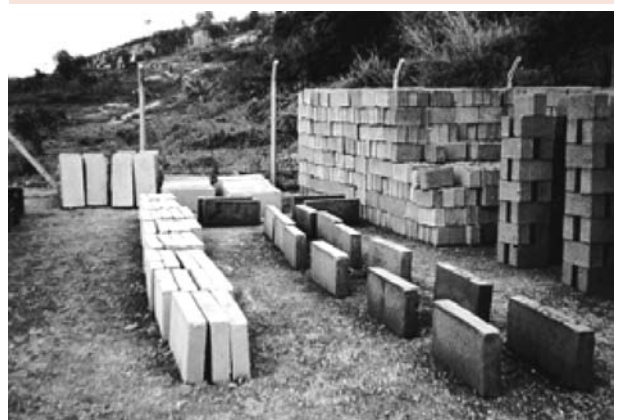
Figura 1d) Guias e blocos produzidos com concreto de RCD.
