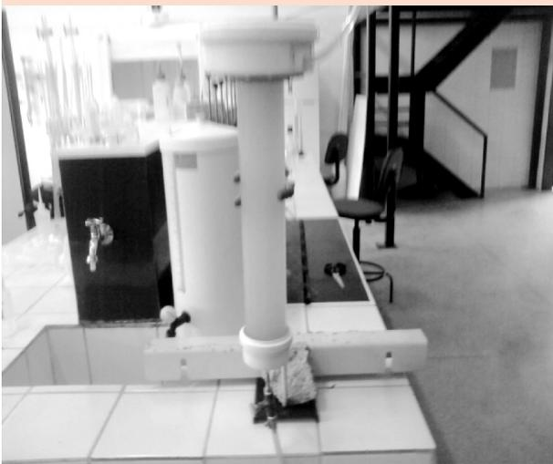
**Figura 2: Reator *air-lift* experimental construído e utilizado**
