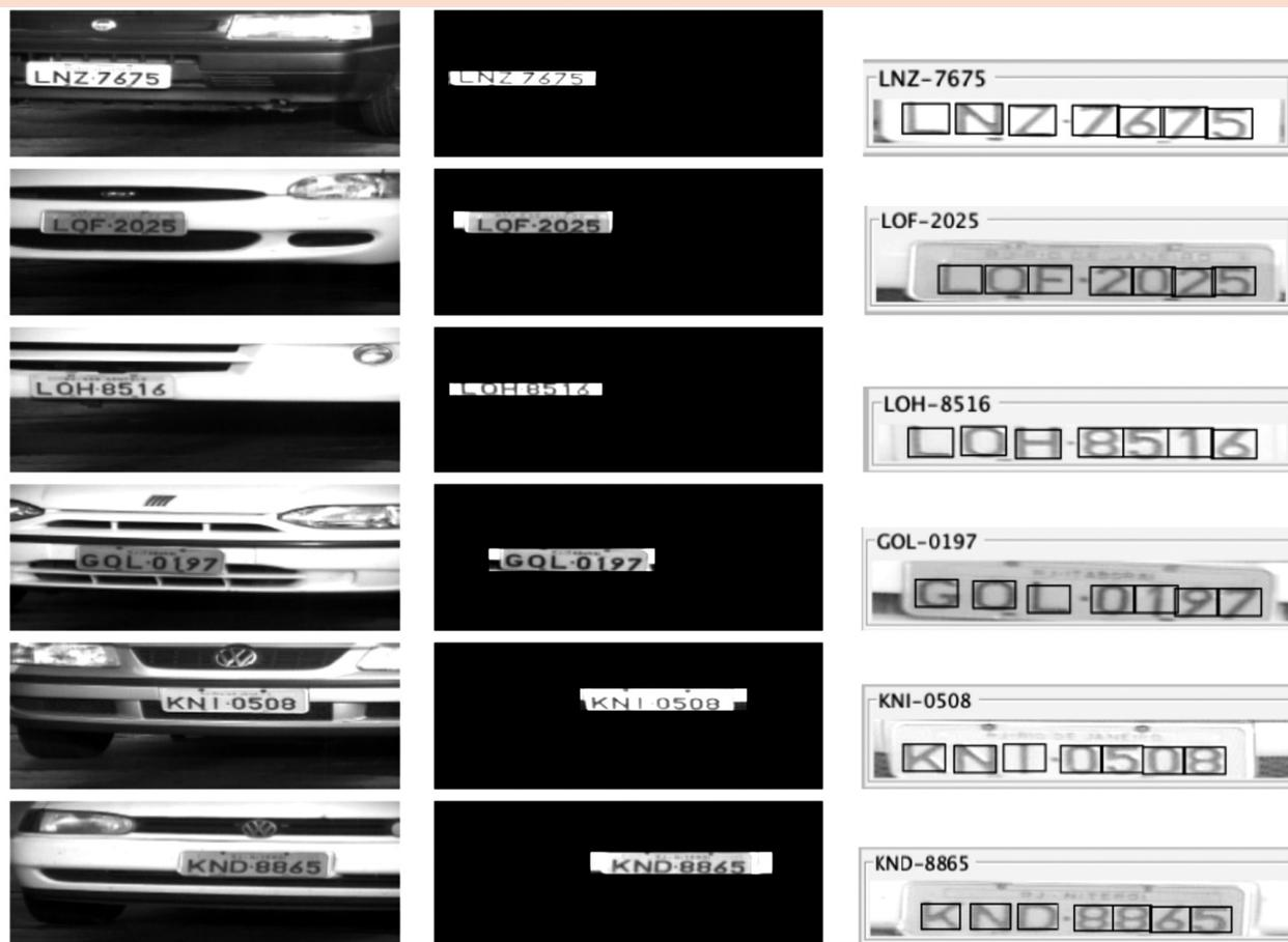
Figura 5: Exemplos da aplicação do método proposto. (a) imagens de entrada; (b) imagens obtidas após etapa de extração da região da placa; (f) imagens mostrando as placas segmentadas e reconhecidas.
