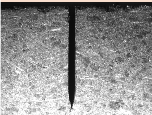
Figura 4: Corpo-de-prova do Material B para teste de flexão a 3 pontos
