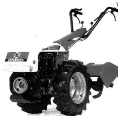
**Figura 2: Motocultivador acoplado ao implemento enxada rotativa**
