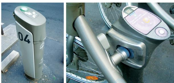
**Figura 4: Suporte de bicicleta do sistema Vélib' (fotografado por um dos autores)**
