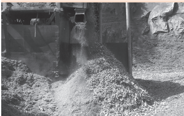
Fotografia 3: Classificação granulométrica dos cavacos de madeira
