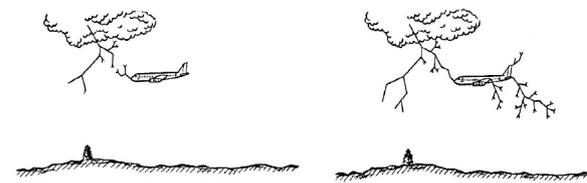
**Figura 6: Conexão da aeronave com o canal progressivo**
