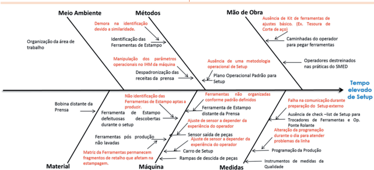
Figura 7 - Diagrama de causa e efeito do tempo de setup Fonte: Registros do grupo de melhoria da empresa.
