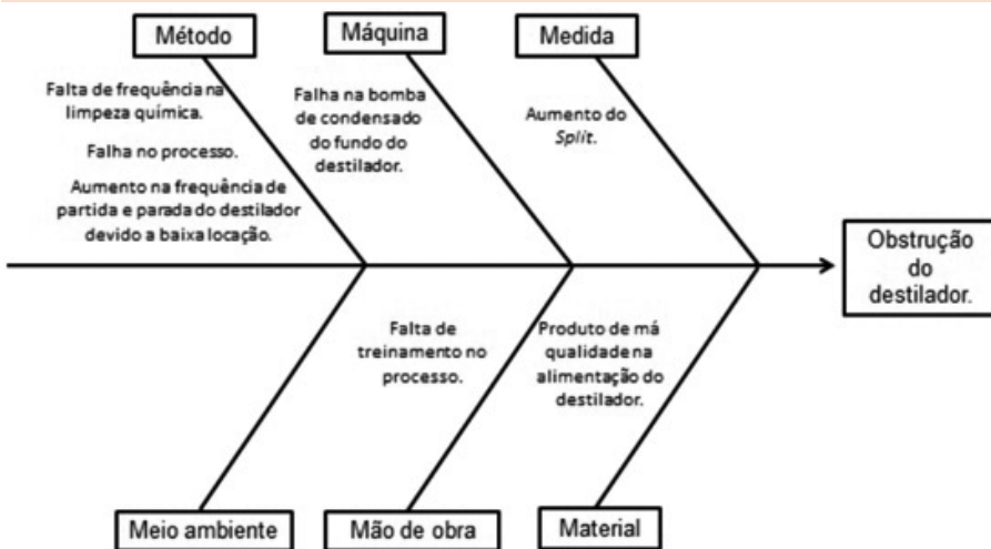
Figura 6: Diagrama de causa e efeito das paradas por obstruções Fonte: Elaboração própria.
