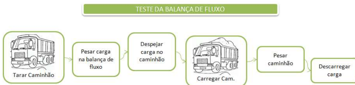
Figura 7 - Esquema representando o teste de balança de fluxo usado neste trabalho
