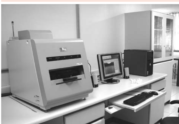
Figura 3: Espectrômetro de Fluorescência de Raios-X por Energia Dispersiva (micro EDX 1300 Shimadzu)
