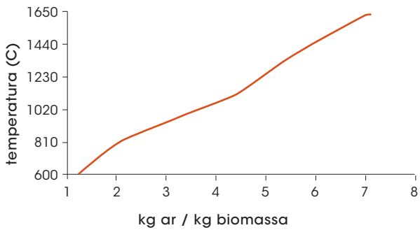
Figura 6: Análise de sensibilidade da obtenção de H2 para fluxo de 39 kg/h de biomassa
