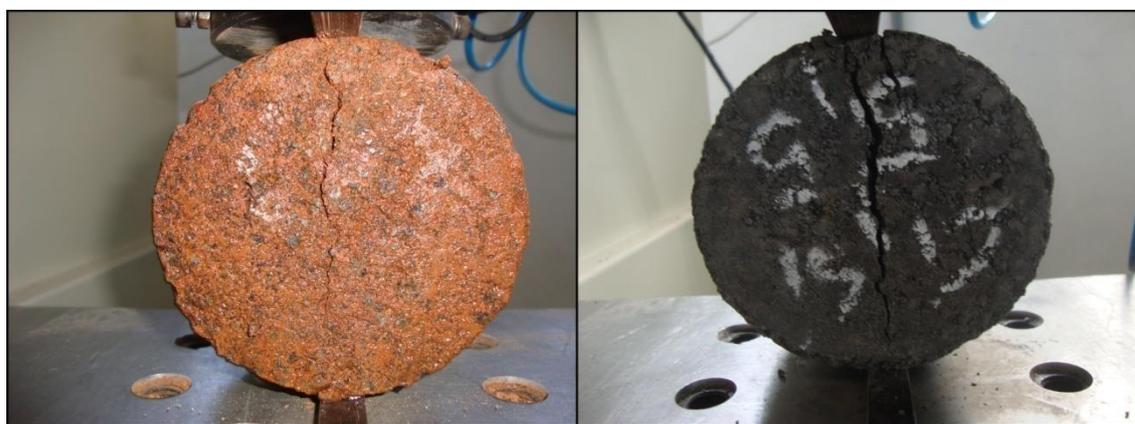
Figura 1 - Comportamento do CP no momento da ruptura
