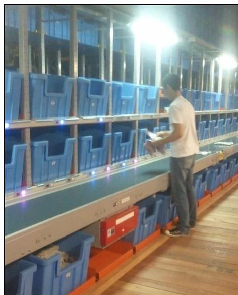
A partir dos dados antropométricos também foi dimensionada a estação de indução manual. A esteira transportadora que leva a caixa até o operador foi projetada com 800 mm de altura e 850 mm de largura para que a caixa seja transportada na posição transversal. A mesa de preparação das
