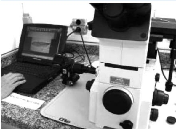
**Figura 3.2:** Microscópio invertido Nikon modelo Eclipse TE2000-U, com câmera Coolpix 5400 digital acoplada, objetiva de 2x
